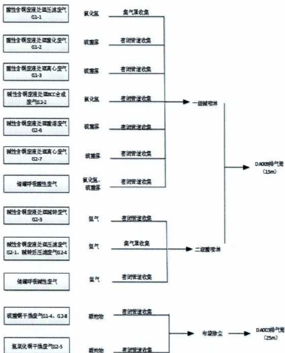
图 7 蚀刻液项目废气处置工艺流程图
