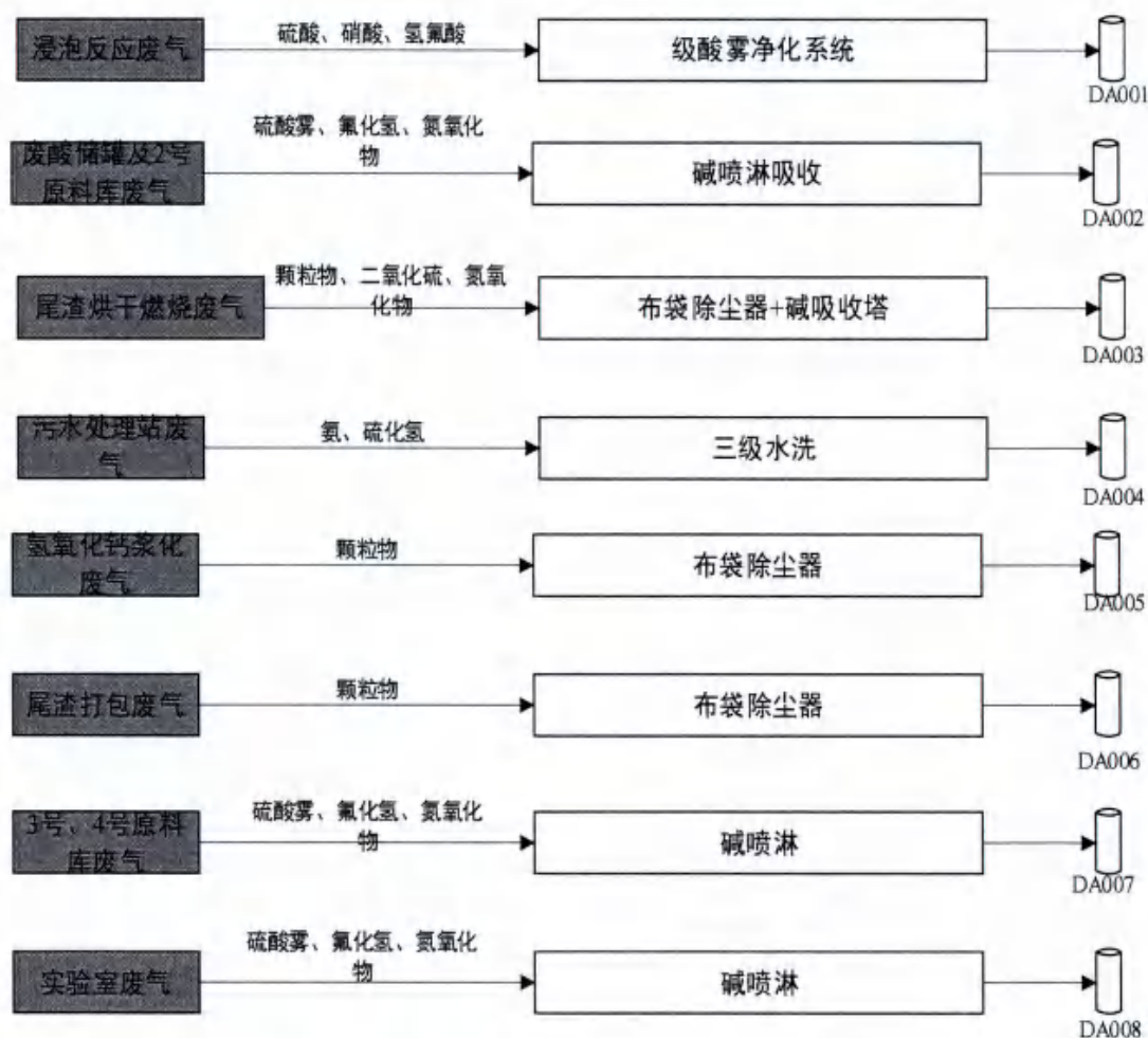
图6 现有项目废气处置工艺流程图
